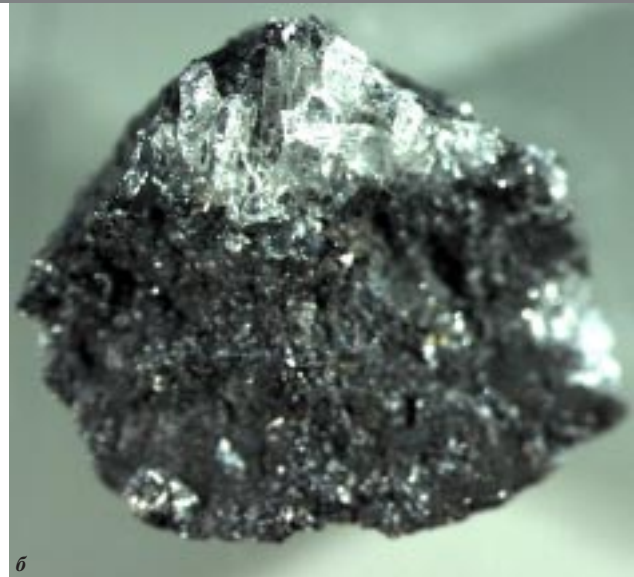
Обычно шунгитовая порода черная и мелкозернистая (а), однако в ней встречаются и сростки кварца, которые выглядят на фотографии как белые пятна (б), и другие минералы, например кубические образования из пирита (в)
